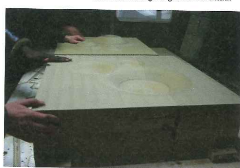
Nelle foto, da sinistra: Progetto grafico di un oggetto per la realizzazione di un prototipo di compensato a curvatura sferoidale. Rappresentazione per linee dell'oggetto. La forma e controforma (stampi) appena uscite dalla macchina CN, realizzate grazie alla collaborazione della Modelliera Ferrieri S.n.c. Gli sfogliati microincisi posti tra gli stampi con i fogli a fibratura incrociata Il prototipo
